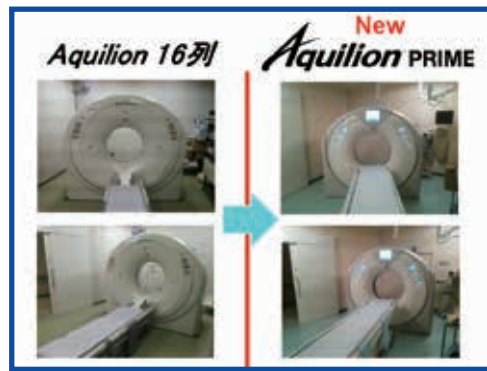
図3 Aquilion PRIME/Beyond Editionを導入コンパクトでガントリ開口径も780mmと広い。
