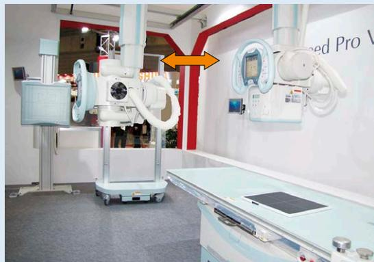
図1 2つのX線管装置の仕事を1つのX線管装置で実現できる一般撮影装置(画像を合成してみました)
