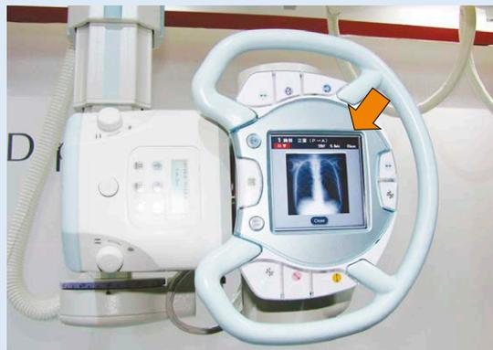
図2 X線管支持器部分に撮影済み画像(←)が表示されます
