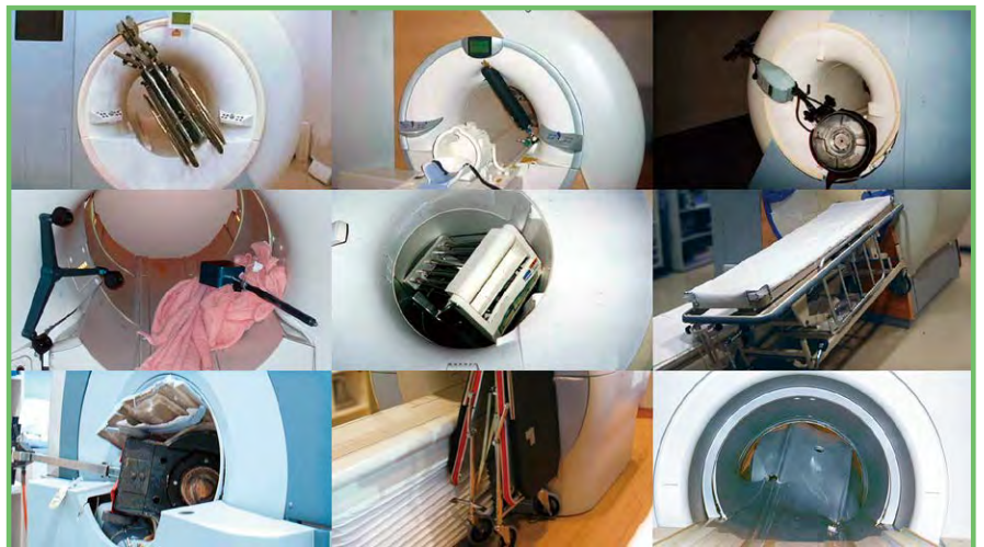
図3 さまざまな吸引事故の例 点滴スタンドや酸素ポンプ、ストレッチャなど大型の備品で発生している。
