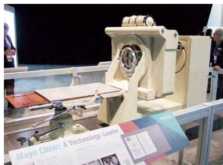
図1 米国で初めて、メイヨークリニックで臨床症例に使用されたCT装置(EMISキャナ)
