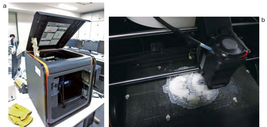
図2 一般コンシューマ向け3Dプリンタの例 a: 一般向け3Dプリンタ(UP BOX, TireTime Technology社製) b: 造形中の様子
