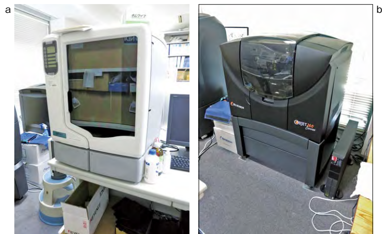
図1 プロフェッショナル向け3Dプリンタの例 a: 熱溶融積層法プリンタ b: 紫外線硬化樹脂噴射法プリンタ
