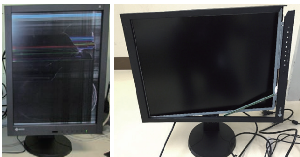
図2 転倒や衝突によるモニタの破損
