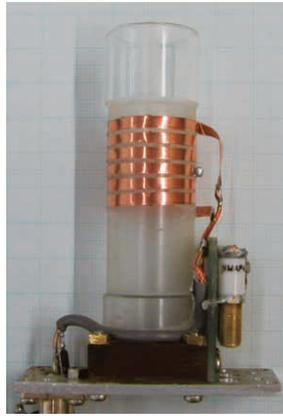
図2 1T (42.58 MHz)用のRFプローブ
